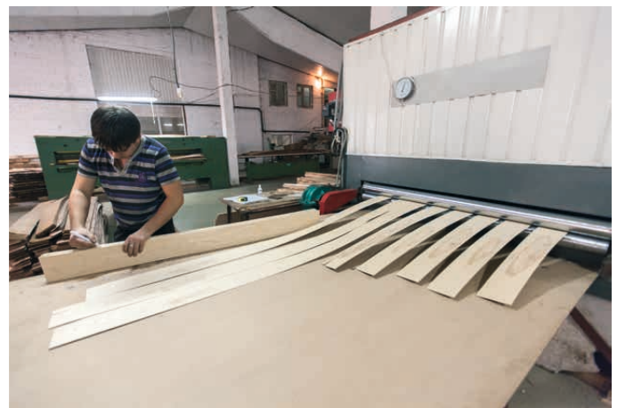
Строгание и сушка шпона на японском оборудовании.
